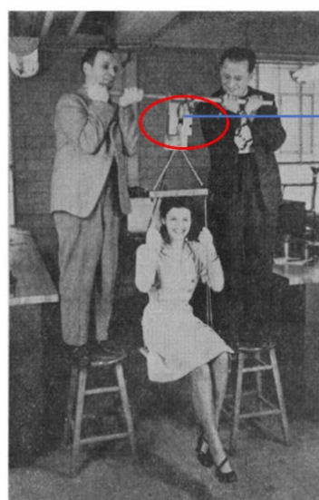
图3 Rabinow 设计的磁流变液演示装置，证明加磁场后的磁流变液可以承受一个 117 磅女孩的重量 [3]
